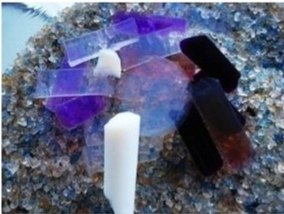
Aerogele sind Festkörper, die eine sehr hohe Porosität aufweisen. Die Fläche eines Gramms Aerogel entspricht etwa 1000 m<sup>2</sup> Foto: TUHH
